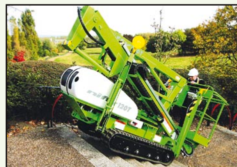
Plošinu lze dodat také na pásovém podvozku (TD120T).
