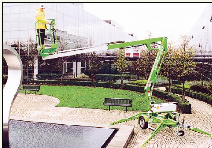
Teleskopické vrchní rameno umožňuje velké boční dosahy.
